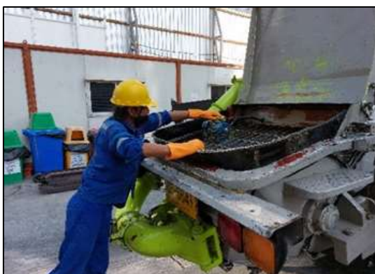
ภาพที่ 14 ใช้น้ำมันหล่อลื่นลดการเสียดสี
