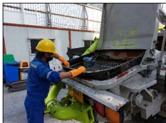
ภาพที่ 14 ใช้น้ำมันหล่อลื่นลดการเสียดสี
